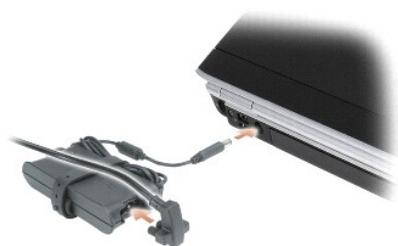
**⚠ PRÉCAUTION** : L'adaptateur secteur fonctionne avec les tensions secteur disponibles dans le monde entier. Cependant, les connecteurs et les rampes d'alimentation varient selon les pays. **L'utilisation d'un câble non compatible ou le branchement incorrect du câble sur la rampe d'alimentation ou la prise secteur peut provoquer un incendie ou endommager l'équipement.**
